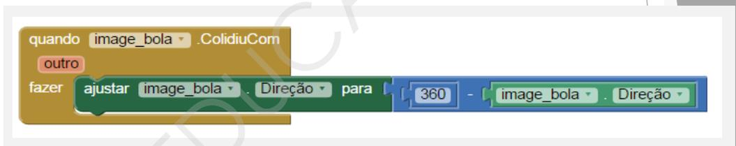
Figura 83: bloco para colidir com o paddle
